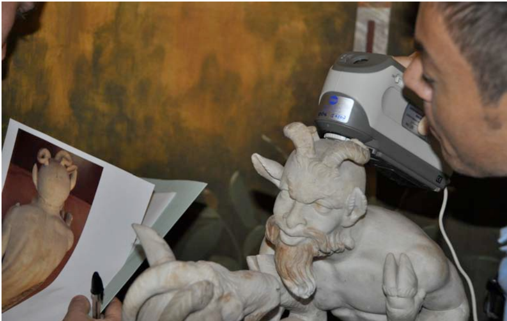
Fase 2. Caratterizzazione cromatica delle superfici mediante spettrofotometro Minolta CM-2600d.
