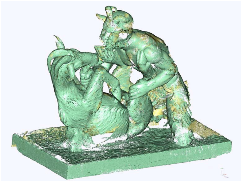
Fase 3. Elaborazione del modello tridimensionale digitale in scala 1:1 nuvola di punti e mesh STL.
