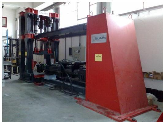
Macchina per prove statiche/dinamiche su elementi strutturali costituita da 2 attuatori trazione/compressione da 2000 kN ciascuno per l'applicazione del carico verticale, 2 attuatori orizzontali servocontrollati statici/dinamici ognuno da 1000 kN e corsa +/- 500 mm (0.42Hz/500mm - 70Hz/1mm), posizionabili ad un'altezza tra 0.5 e 3.5 m, telaio metallico di dimensione 2.30x1.50x4.50 m, parete di contrasto di 4 m di altezza
