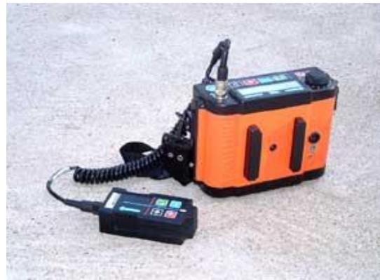
Sclerometro per strutture in calcestruzzo, con energia d'impatto 2.207 N/m – 0.225 mkg, per la misura di resistenze a compressione da 10 a 70 N/mm<sup>2</sup>
