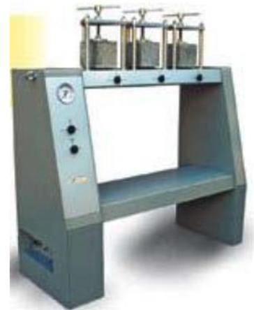
Apparecchiatura per la misura della permeabilità dell'ossigeno, in grado di determinare la permeabilità all'ossigeno di un cemento in conformità con la relazione di Hagen-Poiseuille
