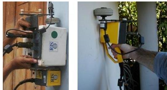
Sistema georadar Aladdin della IDS per l'acquisizione di immagini 3D ad alta risoluzione, comprendente l'unità di acquisizione a tre canali, un'antenna bipolare ad alta frequenza da 2 GHz, tappeto PSG (Pad Survey Guide) di guida nell'acquisizione dei dati, software di elaborazione dati "Gred-3D"
