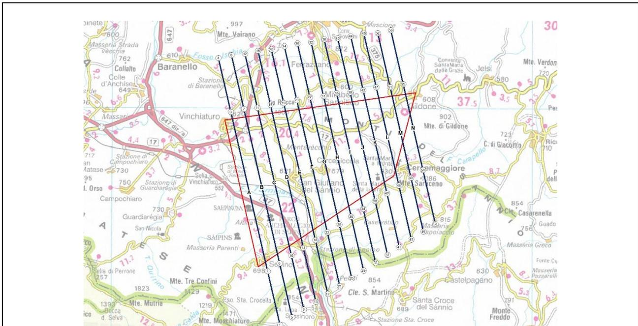
Pianificazione del Volo con sensore CASI 1500 – Camera Phaseone iXA 80
