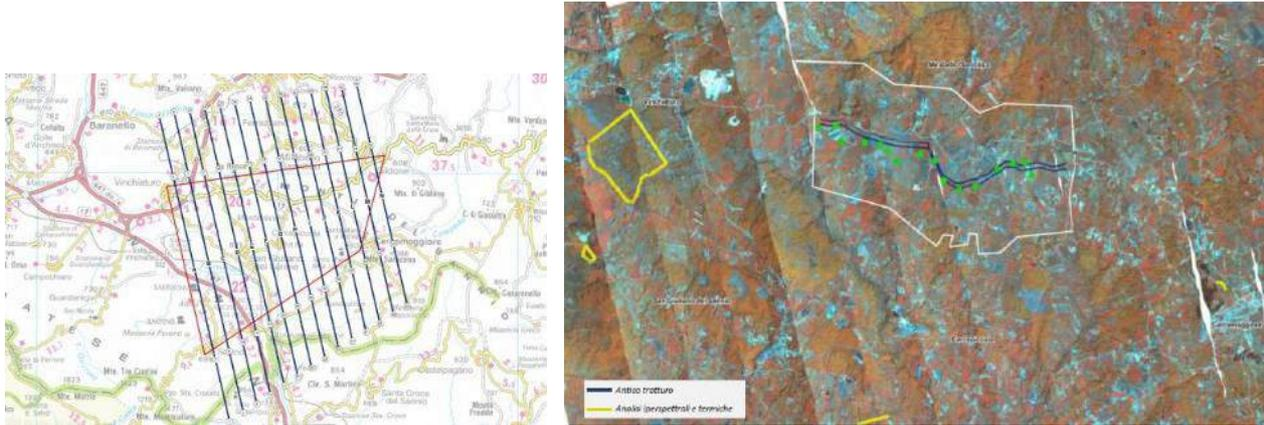
*Pianificazione del Volo con sensore CASI 1500 – Camera Phaseone iXA 80, mosaicura e analisi iperspettrali e termiche*
