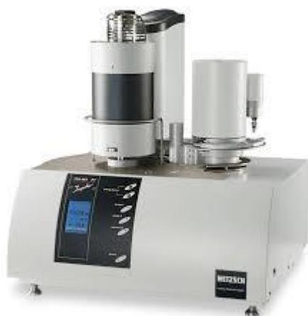
Strumentazione in grado di effettuare la scansione termica sui materiali misurandone le variazioni di massa. La Scansione Calorimetrica Differenziale (DSC) misura il flusso di calore tra due campioni e può essere utilizzato per determinare le variazioni entalpiche. L'analisi Termogravimetrica (TGA) misura le perdite di peso di un campione in funzione della temperatura, utile, quindi a determinare le temperature delle variazioni di fase del campione.
