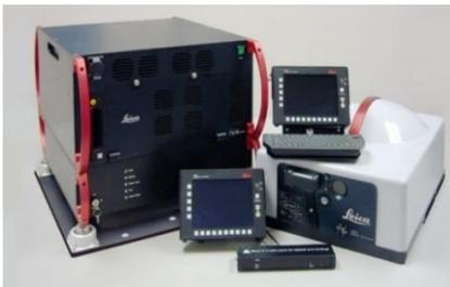
Consente la lettura tridimensionale puntuale del territorio da cui estrarre modelli DSM e DTM ad altissima definizione. Le scansioni LIDAR possono essere integrate con le immagini da ADS40 utili alla modellazione fotorealistica della nuvola di punti.
