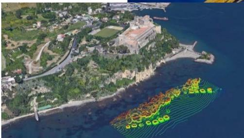
Il Remotely Operated Vehicle permette l'esplorazione video e fotografica in tempo reale di fondali marini, fluviali e lacustri fino ad una profondità di 800 metri; il prelievo di campioni di materiale per classificazione e analisi mirate; il rilevamento tridimensionale del fondale in combinazione con il sensore Multibeam Reson Seabat 8125.
