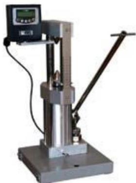
L'apparecchio è costituito da una cella di carico da 60kN azionata da una pompa a mano. Il telaio è regolabile per consentire la prova di campione fino a 102mm di diametro. Un righello montato sul telaio consente una misura diretta della distanza D tra i piani conici prima e dopo la prova. Il carico di compressione è misurato da un trasduttore di pressione con un avanzato display digitale garantendo la massima precisione e resistenza agli shock di rottura.
