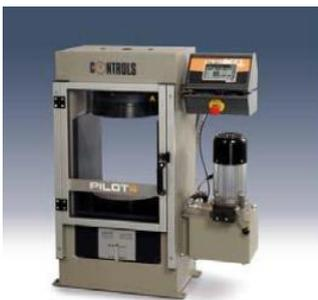
Per determinare la resistenza alla compressione dei provini di calcestruzzo 3000Kn. La macchina può essere corredata da piastrini per prove su blocchi, e di accessori per prove di flessione su travetti, trazione indiretta su cilindri e cubi.
