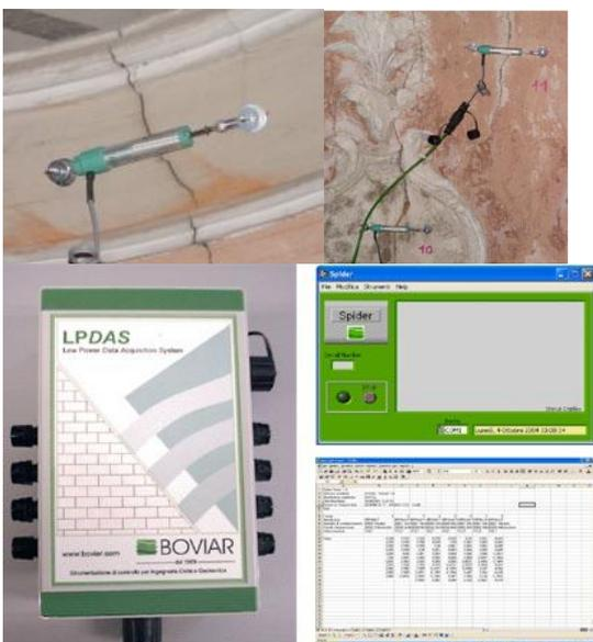
Centralina LP DAS a 8 canali per sensori potenziometrici, corredata con fessurimetri potenziometrici da interno (campo 25 mm) e sonde di temperatura (campo di misura -30°/+70°C, sensibilità 0,5°, accuratezza ±2,5°C), completa di software per la gestione e la memorizzazione dei dati.
