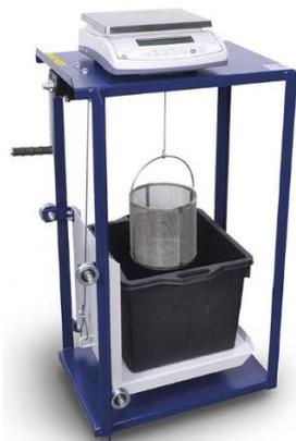
Per determinare la densità del calcestruzzo indurito. Utilizzato in combinazione con un'adeguata bilancia elettronica per la determinazione del peso specifico del calcestruzzo fresco ed indurito ed aggregati. La parte inferiore del telaio incorpora una piattaforma mobile, che porta in contenitore dell'acqua permettendo di pesare provini in aria ed acqua
