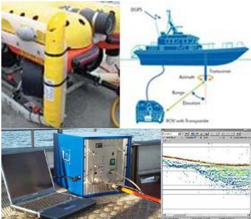
E' un sistema di posizionamento acustico subacqueo dinamico in tempo reale di sommozzatori, sistemi ROV e towfish. Posizionato su un'imbarcazione, il sistema assolve contemporaneamente alle funzioni di ecoscandaglio e di profilatore geologico di profondità.
