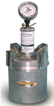
Per determinare il contenuto d'aria occlusa nel calcestruzzo fresco il principio della legge di Boyle.
