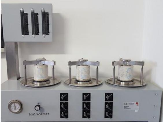
Il test si segue bloccando un prisma di cemento (200x200x120mm) oppure un cubo da 15cm tra due flange con speciali guarnizioni circolari. L'acqua, a pressione controllata, viene poi applicata sulla superficie del campione del cemento. La penetrazione di acqua è misurata alla rottura del campione dopo il periodo di prova, leggendo il livello su burette graduate.
