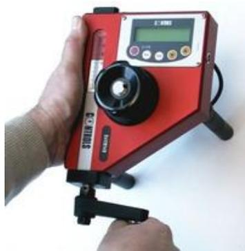
Utilizzato per valutare la forza di legame di due strati di calcestruzzi o la forza adesiva di rivestimenti superficiali (ad esempio intonaco di cemento, calce, gesso a parete ecc.) sul suo supporto. Lo strumento è dotato di un dinamometro munito di una cella di carico a display ad alta risoluzione digitale.
