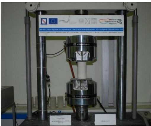
Macchina universale MTS/810 per prove in trazione o compressione, monotone e cicliche, su provini di altezza massima 1.4 metri, in controllo di forza (carico massimo +/- 500 kN) o di spostamento (corsa massima +/- 75 mm), dotata di diversi morsetti in acciaio per sottoporre a diversi tipi di prova elementi in diversi materiali e di diversa tipologia
