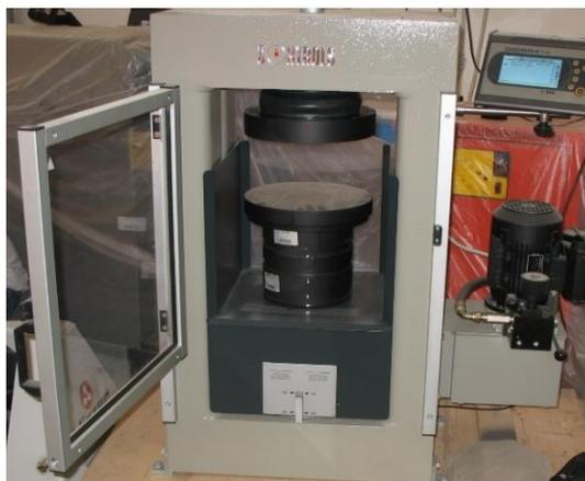
Macchina per prove di compressione su campioni/provini in diverso materiale (carico massimo 3000 kN, distanza massima tra i piatti 320 mm)
