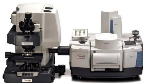
Lo Spettrometro FT-IR viene impiegato per l'identificazione di gruppi molecolari di composti organici in miscele complesse e su superfici. Ogni materiale ha uno spettro IR caratteristico quindi confrontando gli spettri contenuti in una banca dati con quello di un composto incognito è possibile identificare correttamente la molecola incognita.
