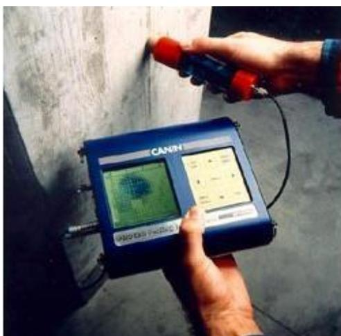
La corrosione del ferro è un processo elettrochimico che decorre dalle aree anodiche (che si corrodono) a quelle catodiche (che si passivano). Dalla misura del potenziale superficiale sulle superficie del calcestruzzo rispetto ad un elettrodo di riferimento standard su una griglia predeterminata, può essere valutata la presenza e la localizzazione di corrosione e stimare le prestazioni future della struttura.
