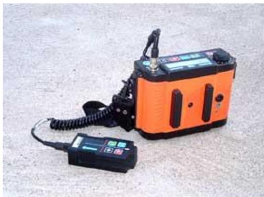
Pacometro digitale ad alta precisione COVERMASTER Elcometer P331-H con kit semicella per analisi della corrosione, con sonda standard, sonda per barre ravvicinate, sonda per barre profonde e sonda da foro, software "Edts" e "CoverMaster®" per il trasferimento e l'elaborazione dati
