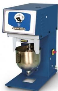
Apparecchiatura per ottenere la miscelazione delle malte in maniera automatica al fine di preparare campioni conformi alle normative previste dai test
