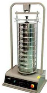
Azione vagliante multipla: orbitale e sussultoria Controllo digitale remoto con pannello separato, microprocessore e display alfanumerico. Funzionamento intermittente o continuo intensità vibrante regolabile, funzione temporizzatore inclusa.
