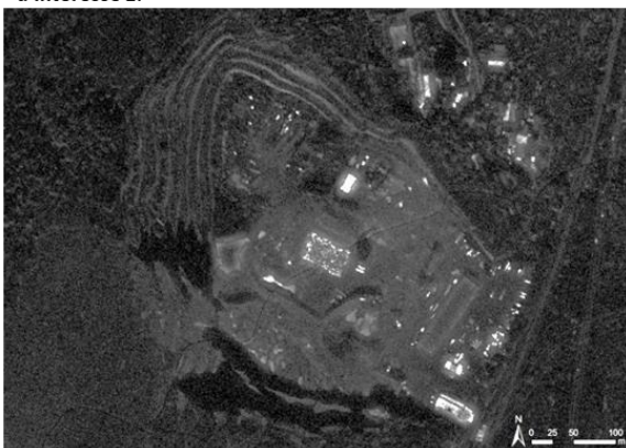
Analisi RXD per l'individuazione delle anomalie spettrali nel sito d'interesse 2.
